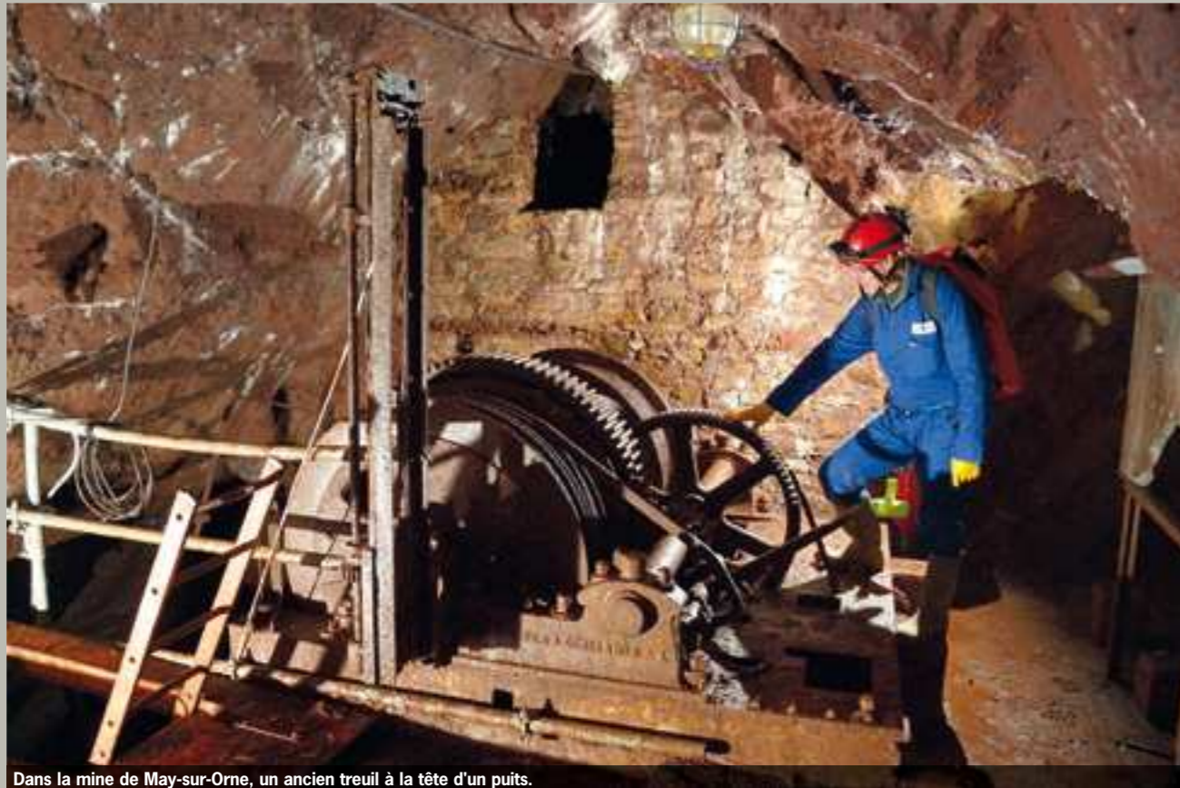
Dans la mine de May-sur-Orne, un ancien treuil à la tête d'un puits.
